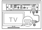
Une fois la configuration correctement effectuée, vous pouvez utiliser la télécommande de votre téléviseur pour régler le volume (VOL +/— et coupure du son avec MUTE) de la barre de son. Connectez le câble HDMI (non fourni) entre la prise HDMI (ARC) de l'appareil et la prise HDMI (ARC) de votre téléviseur compatible ARC.
